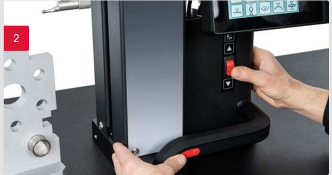
符合人体工程学的拨轮和功能键使操作人员能够轻松快速地定位测头并开始测量。对于非常大的工件，通过手柄中的按钮启动气浮系统支持精确定位设备。
