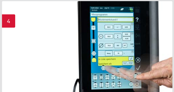
轻松的拖放任务和内置的 ISO 公差表使创建测量程序变得非常容易。
