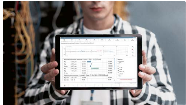
Ausschnitt aus der Option „RoughnessPlus“. Virtuelle Lineale zum interaktiven Festlegen von Abständen in X- und Z-Richtung im Profilfeld
