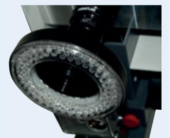
**Quadranten-LED-Ringlicht** (optional koaxiales Aufsicht für eine optimale Ausleuchtung von unifarbenen Oberflächen)
