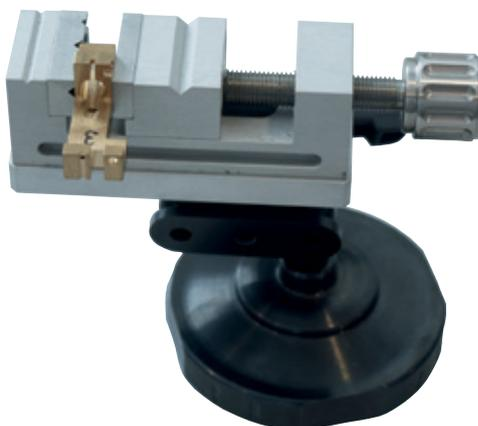
Schraubstöcke mit Stativ in 3 Größen
