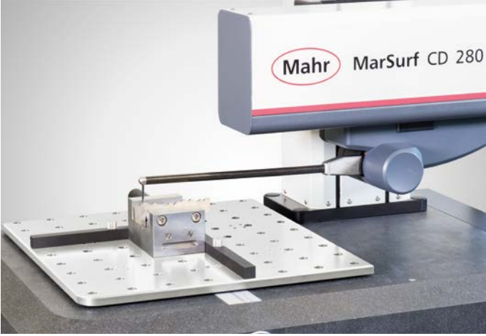
Eğitim standardında CPG A 36-350-25/12° standart probu ile ölçüm
