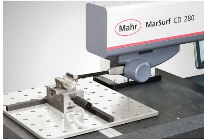
CPG A 33-210-25/30 \varnothing 50 yandan tarama probu ile ölçüm
