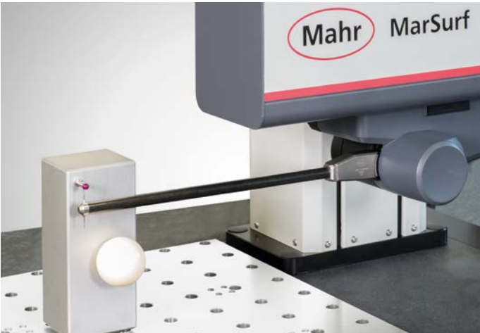
Kalibrasyon standardında, çift taraflı prob ucuyla ölçüm
