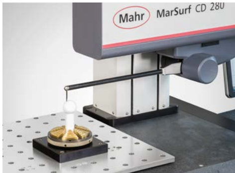
Çeneli ayna ile Mafsal bilyası bağlama
