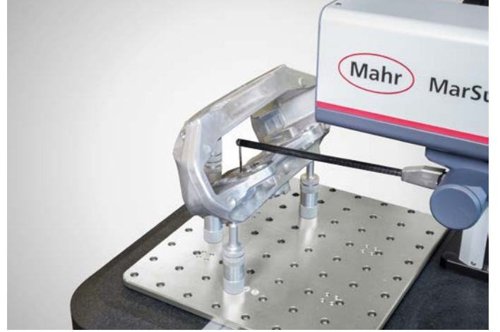
CPG A 62-350-25/19° uzun prob ucuyla ölçüm, daha derin seviyelerdeki ölçüm yerlerine erişim olanağı sağlar
