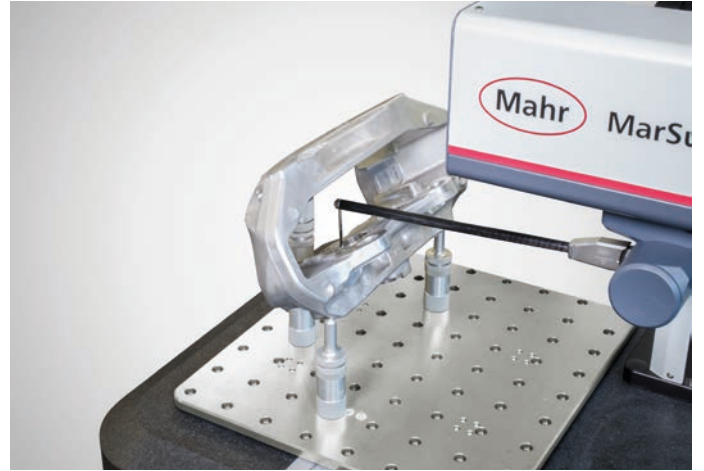
CPG A 62-350-25/19° 긴 프로브 팁을 사용하여 낮은 측정 위치 접근 및 평가 가능
