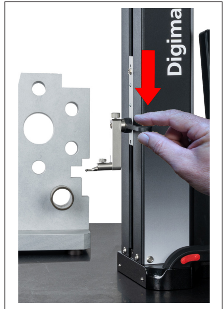
图 13 使用定位手柄向下移动滑块
