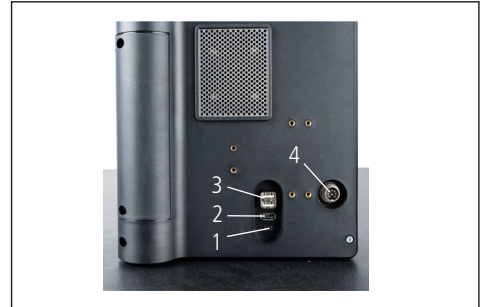
图 9 USB 插口 1 Mini USB 2 1 x USB 3.1 (黑色) 3 2 x USB 3.1 (白色) 4 8 针圆形插头，用于为控制面板供电
