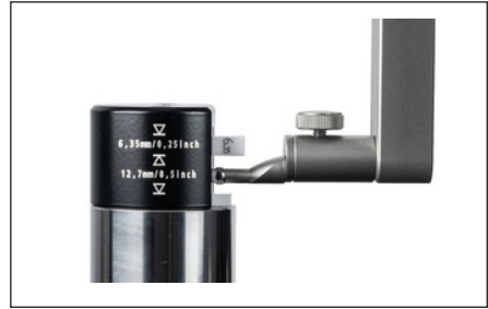
图 12 用凹槽校准时定位校准块
