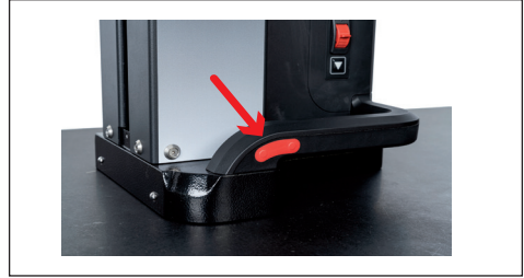
图 5 用于激活气浮的按钮 (插图仅显示了 Digimar 817 CLT。)
