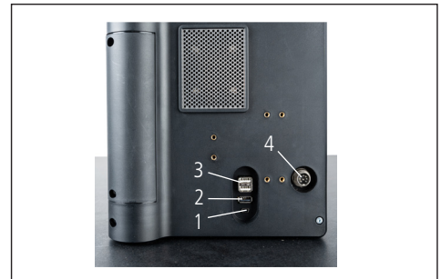
Fig. 9 Conexões USB 1 Mini-USB 2 1 x USB 3.1 (preto) 3 2 x USB 3.1 (branco) 4 Conector redondo de 8 pinos para a alimentação elétrica do painel de operação
