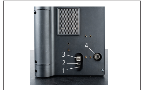
図 8 USBソケット 1 Mini USB 2 1 x USB 3.1 (黒) 3 2 x USB 3.1 (白) 4 8ピン丸型プラグ (コントロールパネル電源用)
