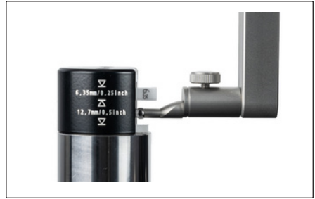
図 11 溝で較正時の設定ゲージの位置決め
