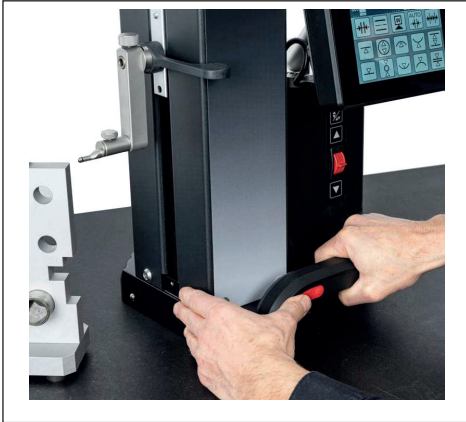
図 6 作動したエアベアリングを使用して、本機器を移動 (図はDigimar 817 CLTのみを示しています。)
