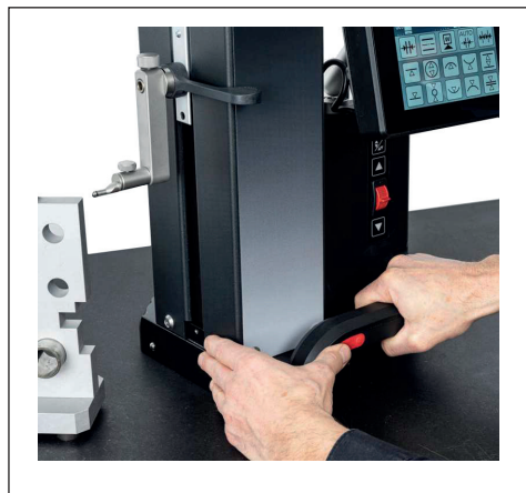
Fig. 7 Spostamento dell'altimetro mediante il cuscinetto pneumostatico attivato
