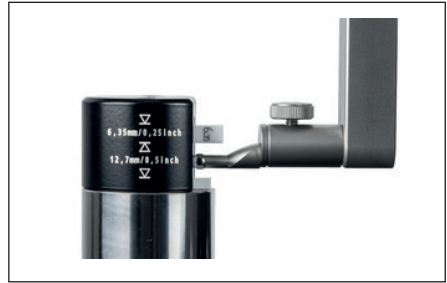
Fig. 12 Posizionamento del master di riscontro durante la calibrazione con cava
