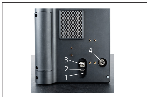
9. ábra USB csatlakozóaljzatok 1 Mini USB 2 1 db USB 3.1 (fekete) 3 2 db USB 3.1 (fehér) 4 8 pólusú kerek csatlakozódugó a kezelőpanel feszültségellátásához
