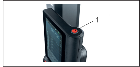
Fig. 2 Interruptor de encendido y apagado
