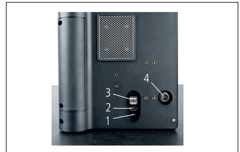
Fig. 9 Conectores USB 1 Mini USB 2 1 conector USB 3.1 (negro) 3 2 conectores USB 3.1 (blancos) 4 Conector redondo de 8 pines para el suministro de corriente del panel de control
